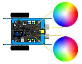
RGB LED 可分別控制紅、綠、藍 LED 發光強度,混合出全彩效果(16,777, 216 種顏色變化)
